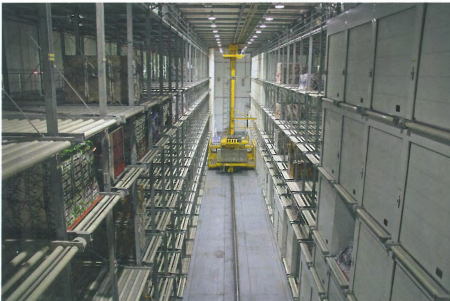
Zwei Regalbediengeräte übernehmen die vollautomatische Ein- und Auslagerung im Lager.
