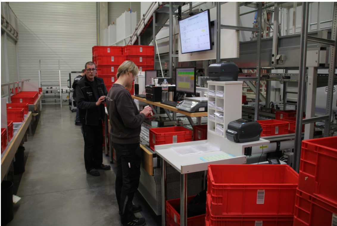
Ware-zur-Person Kommissionierung setzt in der Regel ein automatisches Kleinteilelager (AKL) voraus. ©Unitechnik
